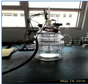
Gambar 1. Sel polarisasi dengan menggunakan 3 elektroda
