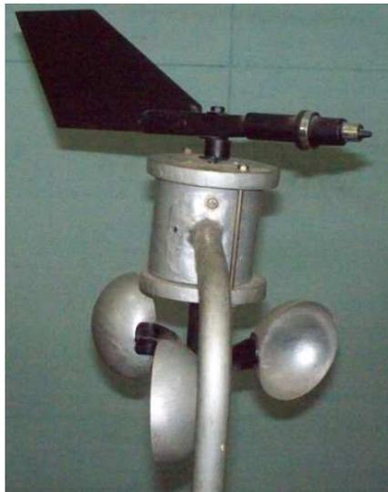
Gambar 3. Sensor Arah Angin dan Kecepatan Angin
