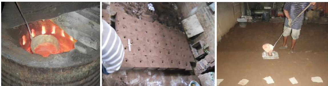
Gambar 4. Peleburan logam dan pengecoran dengan pasir cetak
