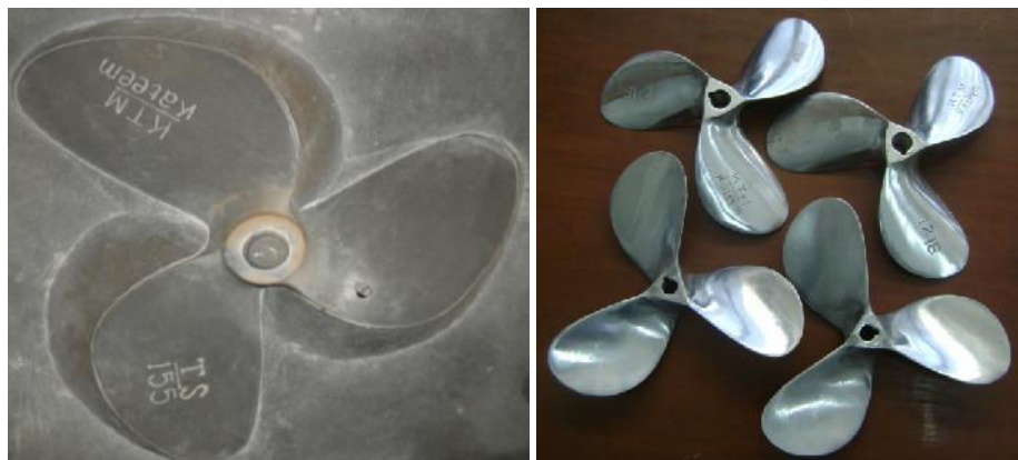
Gambar 5. Pola cetakan logam dan produk cor propeler kapal tiga sudu
