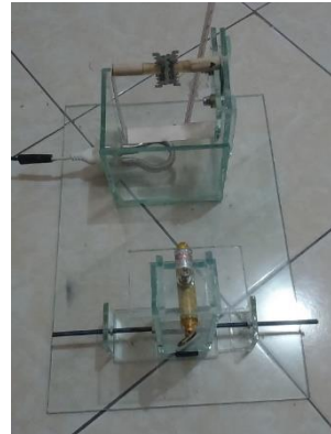
Gambar 1. Alat untuk Menentukan Koefisien Pemuaian Panjang dengan Metode Difraksi Celah tunggal
