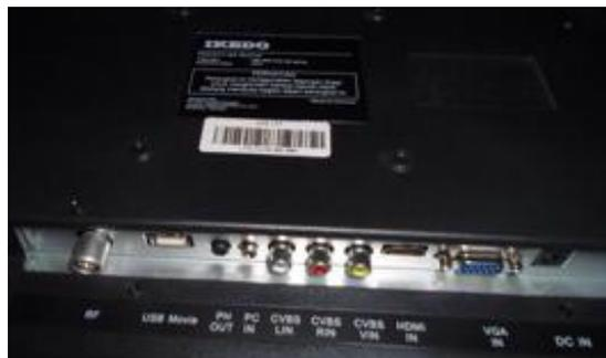
**Gambar 8. *Port-Port* Input pada LCD**
