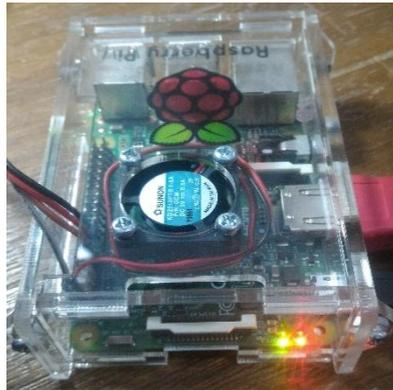
**Gambar 4. Lampu Indikator pada *Board Raspberry Pi***
