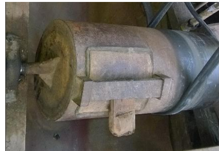
Gambar 3. Pengambilan emas dengan Proses Amalgamisasi
