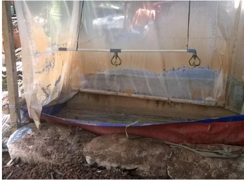
Gambar 4. Proses Ekstraksi Bijih Emas Heap Leaching.
