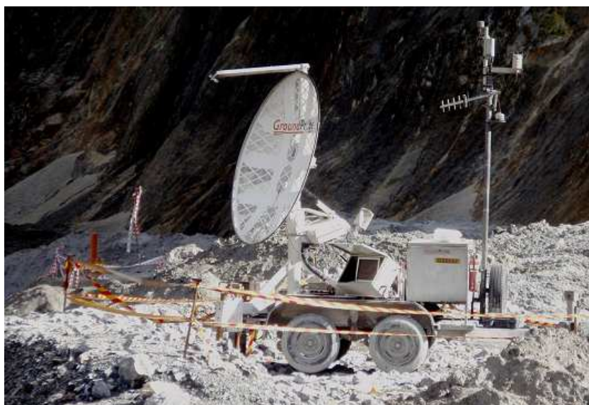
Gambar 5. Radar yang Memantau Dinding
