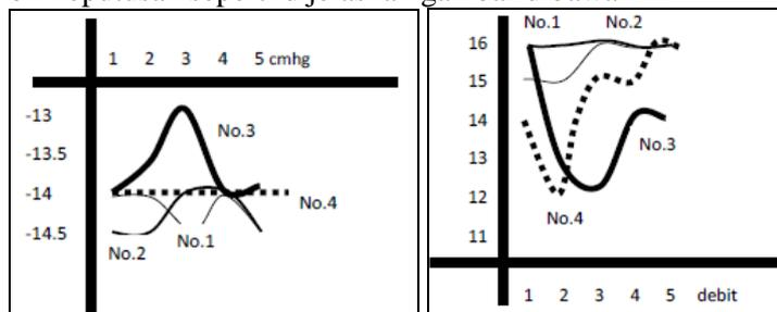
Gambar .5 Grafik Hasil pengujian tekanan hisap (cmHg) dan debit aliran (m<sup>3</sup>/mnt)
