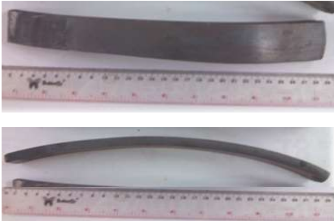
Gambar 4. Bentuk spesimen hasil pengerolan panas
