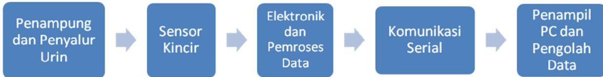
**Gambar 1.** Blok diagram sistem yang direncanakan.
