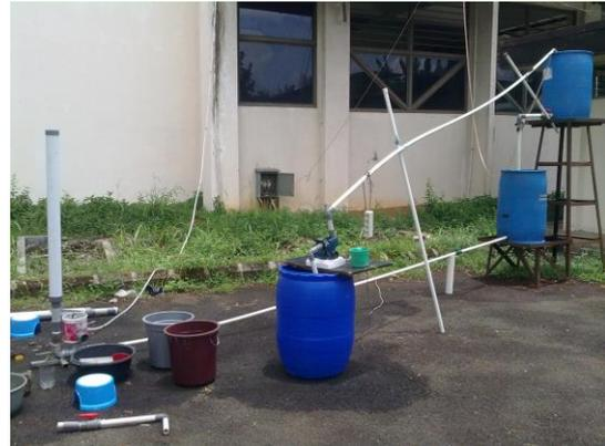
Gambar 6. Hasil pemasangan pompa *hydraulic ram pump* untuk model alat uji sistem irigasi dan pembangkit listrik.
