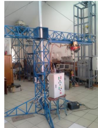
Gambar 3. Plant miniatur tower crane
