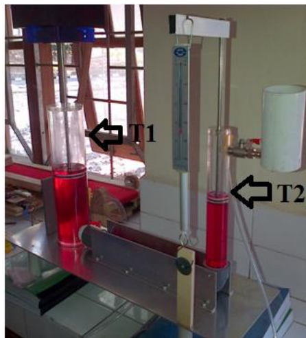
Gambar 4. Alat Praktikum Hukum Pascal dengan Variasi Luas Bidang Sentuh 1
