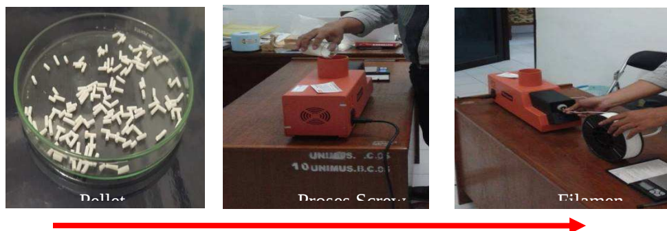
Gambar 2. Proses pembuatan filamen biodegradasi printer 3D
