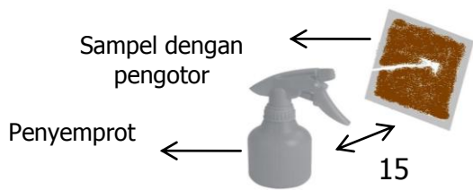
Gambar 3. Skema penyemprotan sampel pada pengujian self cleaning
