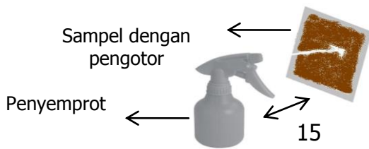
Gambar 3. Skema penyemprotan sampel pada pengujian self cleaning
