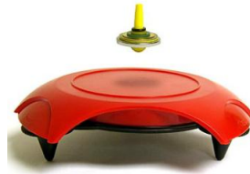
Gambar 2. Levitron ( The magnetically levitating top ) sebagai peraga edukatif dalam menerangkan topik giroskop dan magnet kepada para mahasiswa [3]
