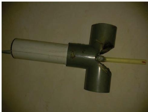
**Gambar 2.** Sensor aliran fluida
