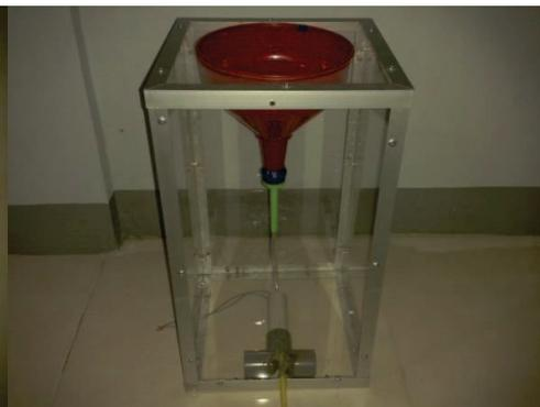
**Gambar 3.** Perangkat pengukur curah hujan
