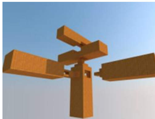
Gambar 6. Simulasi sistem sambungan antara tiang dan balok lantai (Sumber : Dokumentasi Penulis, 2013)
