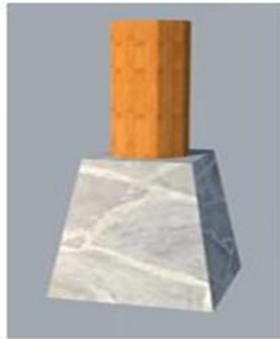
Gambar 3: Bentuk pondasi hasil modifikasi
