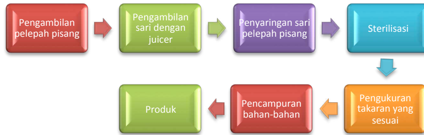
Bagan 1. Proses Produksi “Handsang” (Hand Sanitizer Berbahan Utama Pelepah Pisang).
