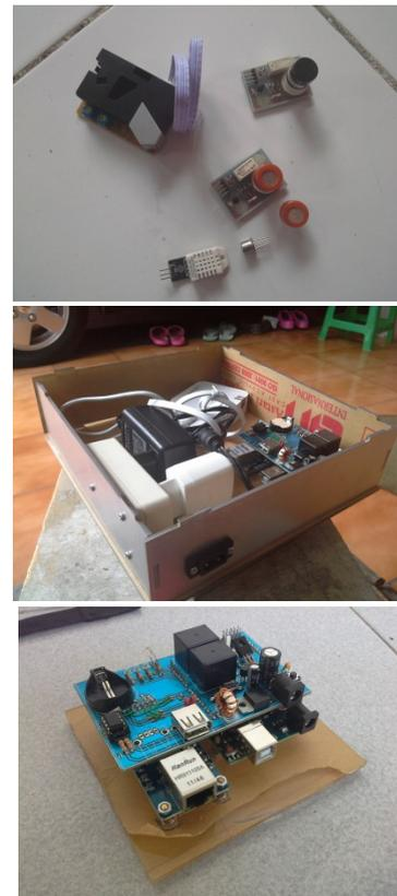
Gambar 5. Perangkat akuisisi kadar polutan di udara berbasis mikrokontroler: sensor yang digunakan (atas), kemasan perangkat sensor (tengah), dan rangkaian akuisisi sensor elektronik dengan mikrokontroler dan port ethernet (bawah).
