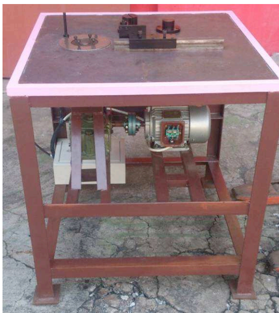
Gambar 2. Rancang bangun alat pembuatan teralis
