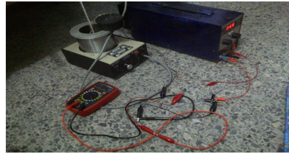
Gambar 1. Set rangkaian uji coba IC LM35 sebagai sensor suhu
