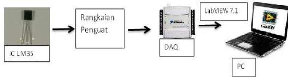
**Gambar 3.** Blok Perangkat Keras Akuisisi Data
