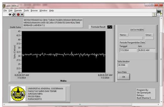
**Gambar 8.** Tampilan program eksekusi sistem pemantau suhu
