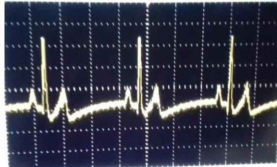
Gambar 3. Hasil Pengujian dengan ECG simulator
