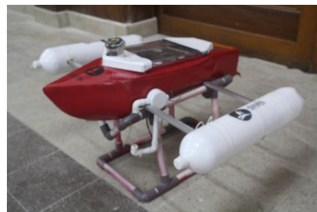
Gambar 1.2. SI PENYU Tampak Samping Kapal “SI PENYU” terlihat pada gambar di atas, dari gambar tersebut kapal ini merupakan kapal duamaran yang artinya mempunyai dua penyeimbang dibagian samping kanan dan kiri kapal. Rancangan tersebut agar memudahkan keseimbangan
