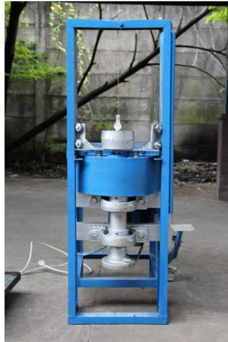
Gambar Mesin Pemisah Tutup Gelas Mineral
