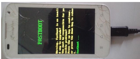
Fig. 10. Proses Instalasi CWM pada Smartphone 2 dengan tools fastboot
