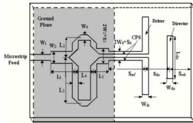
Gambar 3. Skematik Diagram Uniplanar Quasi Yagi Antenna
