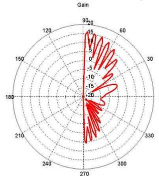
Gambar 7. Gain Antenna Yagi untuk RFID
