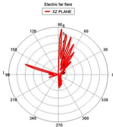
Gambar 7. Hasil Radiasi Gain XZ Plane
