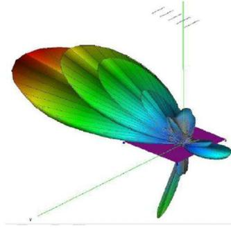
Gambar 6. Pola Radiasi Antenna Yagi untuk RFID
