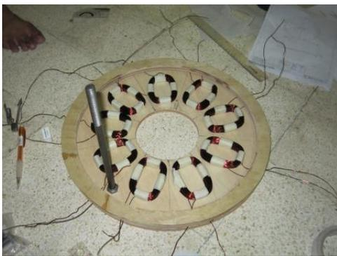
Gambar 6. Proses pengerjaan stator. kanan : Hasil cetakan stator dengan resin
