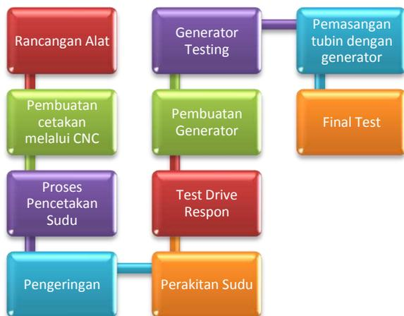
Gambar 5. Flowchart keseluruhan pembuatan turbin Heliks
