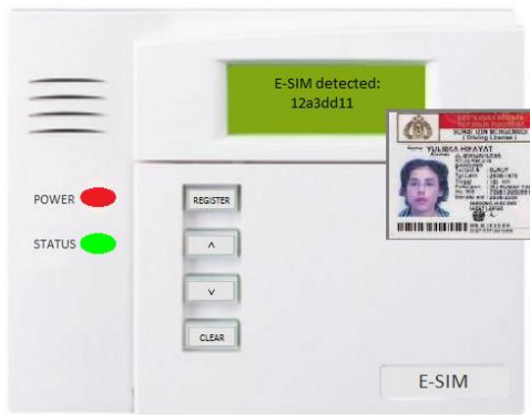
Gambar 5. Sistem Saat Mendeteksi Adanya Tag RFID (E-SIM)
