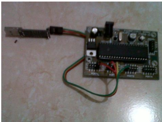
Gambar 7. Minimum Sistem dan USB to TTL Converter
