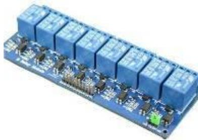
Gambar 2. Modul DI-Relay 8
