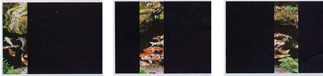
Gambar 6 Shutter yang bertipe focal plane dengan 5 posisi lempengan
