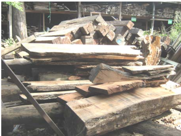
Gambar 5 Log kayu bagian bawah pohon, limbah dari perusahaan penggergajian, bantalan rel kereta api serta bongkaran dari rumah.
