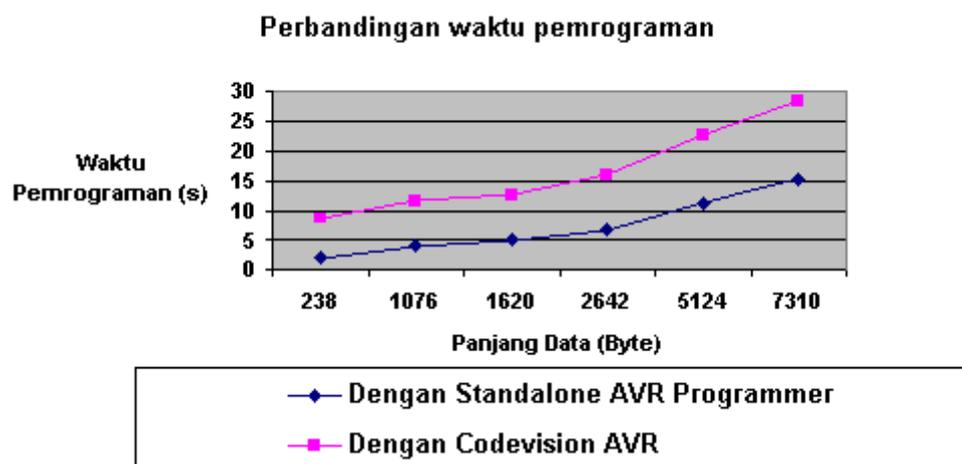
Gambar 8 Grafik Perbandingan Waktu Pemrograman antara Standalone AVR Programmer dengan Codevision AVR
