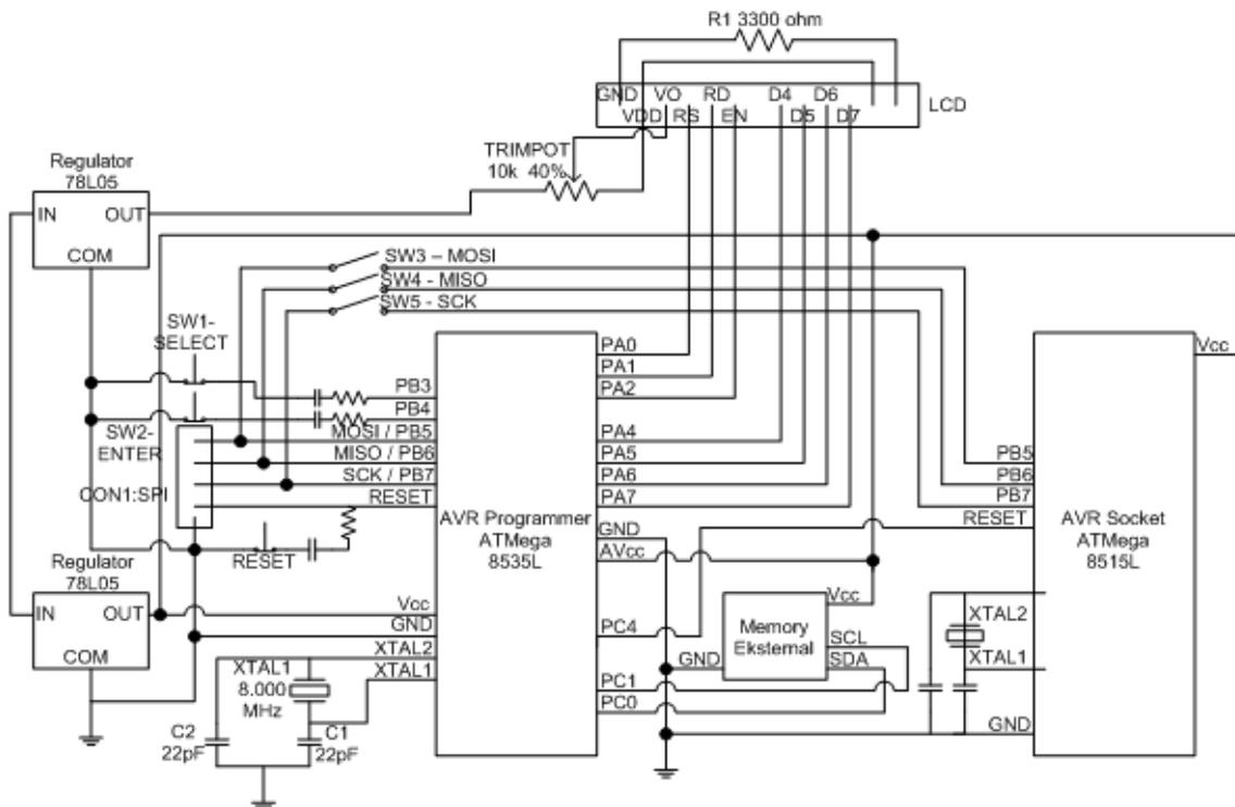
Gambar 2 Skematik Rangkaian AVR Programmer
