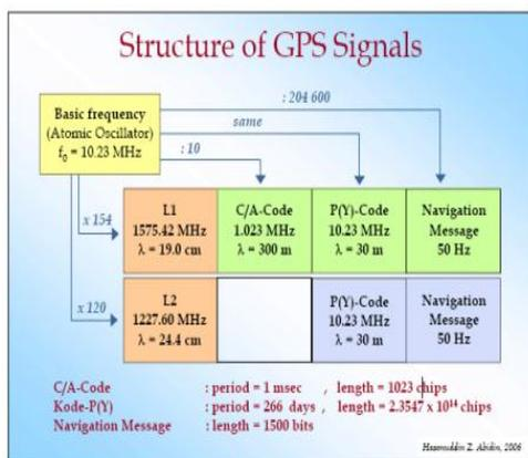
Gambar 2.1 Struktur Sinyal GPS
