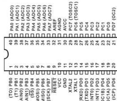
Gambar 2.3 Posisi Pin AVR ATMega 8535
