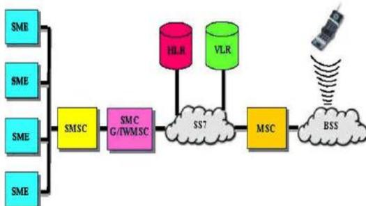
Gambar 2.6 Sub Sistem SMS Pada Jaringan GSM
