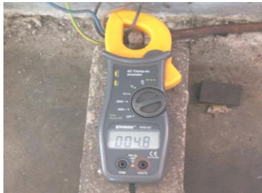
Gambar 3.4 Pengukuran arus listrik
