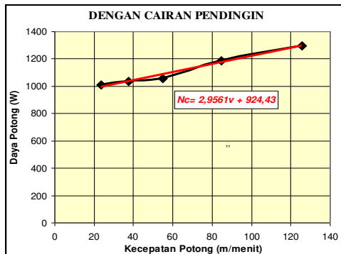
Gambar 4.2 Grafik kecepatan potong terhadap daya potong pembubutan dengan cairan pendingin
