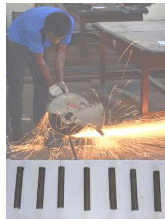
Gambar 3.2 Proses pembuatan benda uji
