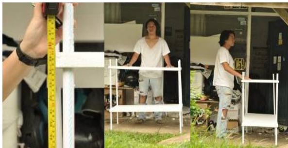
Gambar 3. Ukuran worktop dapur yang digunakan sebagai acuan mendesain, berdasarkan tinggi rata-rata orang Indonesia, yaitu 163 cm. Tinggi worktop adalah 90 cm, diukur berdasarkan kenyamanan dan ukuran ergonomi yang sudah ada.
