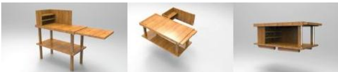
Gambar 4. Desain ini menggunakan material kayu dengan kaki yang dapat dilipat dan rak yang dapat dipindahkan ke bawah worktop saat tidak dipakai. Dapur ini didesain untuk dapur yang berbahan bakar gas elpiji. Tapi ternyata produk ini sulit dimobilisasikan dan sistem kunci kaki meja yang rentan sehingga tidak cocok digunakan karena worktop dapur harus kokoh dan kuat.
