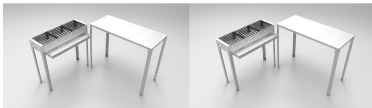
Gambar 10. Gambar ilustrasi desain akhir dengan sistem knock-down . Kaki meja menggunakan besi siku agar struktural lebih kuat. Tiap komponen digabungkan dengan baut agar lebih kuat.
