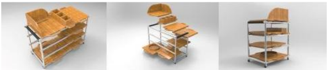
Gambar 5. Desain ini merupakan desain dapur mobile yang menggunakan sistem seperti trolley yang yang bisa didorong dan tiang penyangganya bisa diperpanjang sesuai kebutuhan dan worktop -nya bisa ditambahkan sesuai dengan yang dibutuhkan. Desain awal ini masih menggunakan bahan bakar gas elpiji dan worktop -nya menggunakan material kayu laminasi. Namun, kayu laminasi kurang cocok untuk dijadikan worktop karena tidak tahan terhadap panas tinggi.
