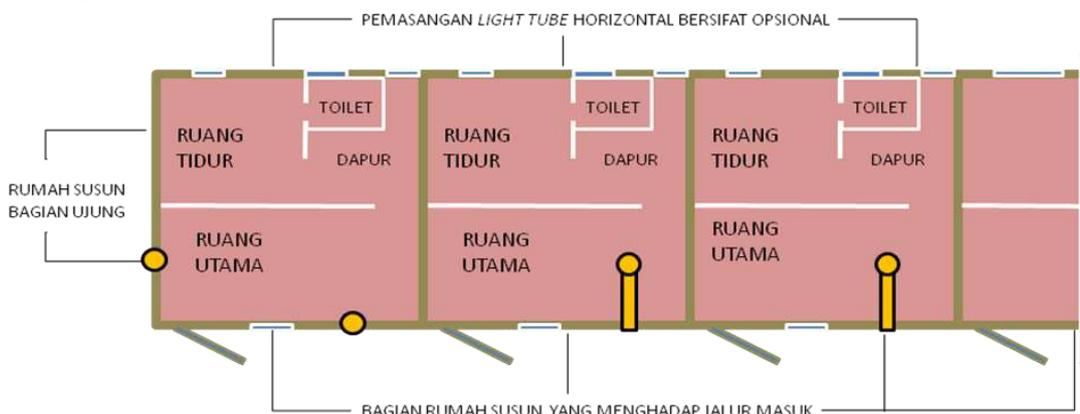
**Gambar 10.** Tampak Atas dari Penempatan *Light Tube* Horizontal pada Rumah Susun di Lantai Teratas
