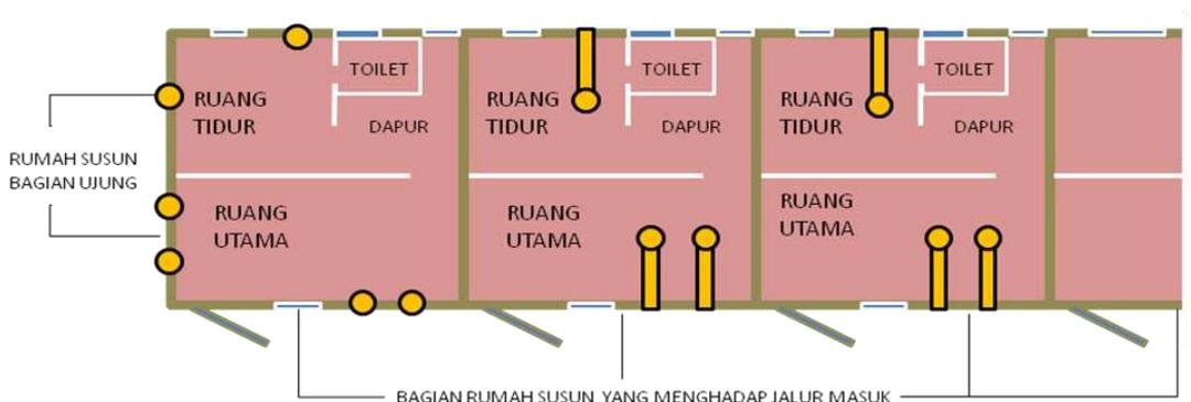
**Gambar 11.** Tampak Atas dari Penempatan *Light Tube* Horizontal pada Rumah Susun di Lantai Selain yang Teratas
