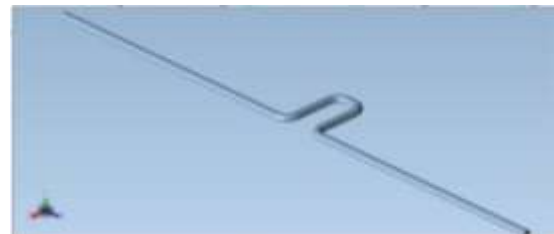
Gambar 10. Model loop ekspansi untuk tipe horizontal
