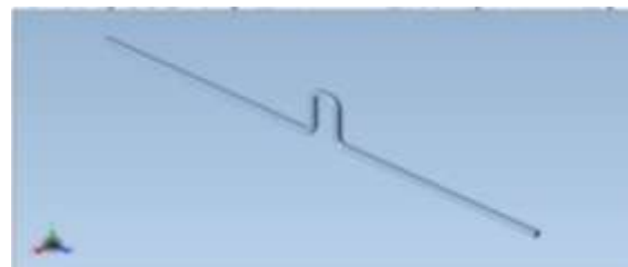
Gambar 11. Model loop ekspansi untuk tipe vertikal
