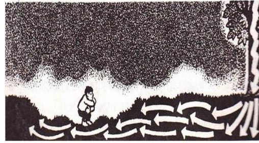
Gambar 2. Proses terjadinya tegangan langkah dan cara menghindarinya[13]
