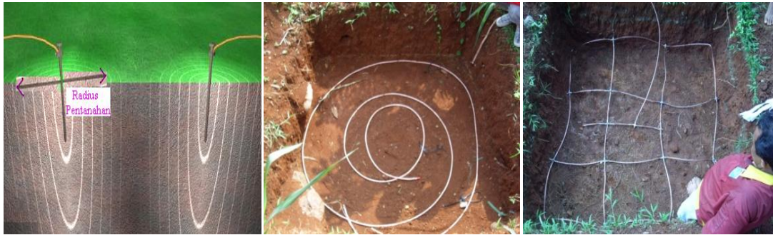
Gambar 4. Titik pentanahan metode rod, lingkaran dan mesh [2]
