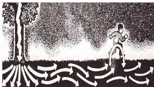
Gambar 1. Proses tegangan langkah
