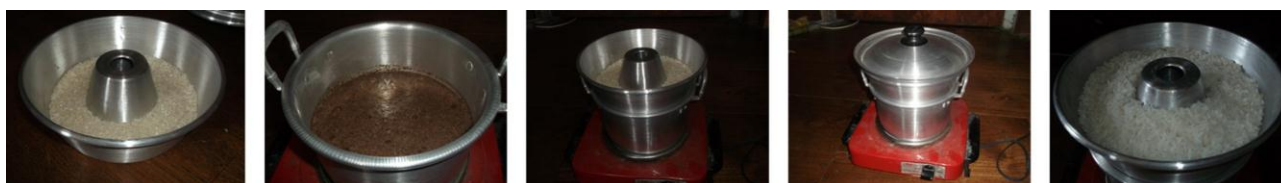
Gambar 5. Eksperimen Teknis Kedua. Kukusan bolu diisi beras dan ditumpuk di atas panci berisi air kotor. Kukusan bolu ditutup dengan tutup panci, kemudian sistem ini dipanaskan. Hasil eksperimen membuktikan bahwa uap dari air kotor yang tertampung di dalam kukusan bolu dapat digunakan untuk menanak nasi hingga matang.
