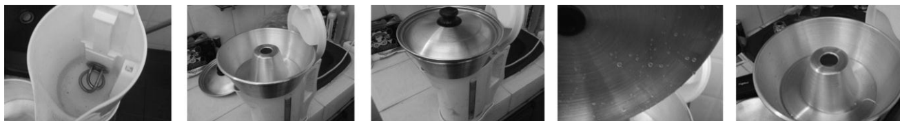
Gambar 4. Eksperimen Teknis Pertama. Dengan menumpuk kukusan bolu di atas pemanas air dan ditutup dengan tutup panci, dihasilkan sistem sederhana yang serupa dengan konsep dasar desain. Air kotor yang dipanaskan di dalam pemanas air menguap dan mengembun di dalam kukusan bolu, membuktikan proses penghasilan air bersih dapat terjadi.
