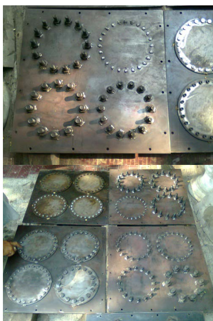
Gambar. 7 bolt dan screw yang terpasang pada plat
