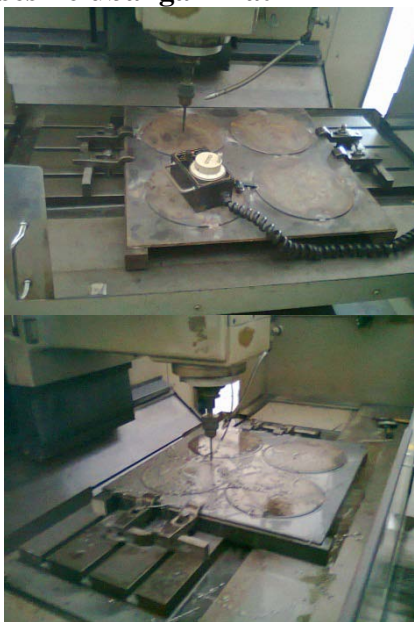
Gambar. 6 Pelubangan plat pada Mesin CNC
