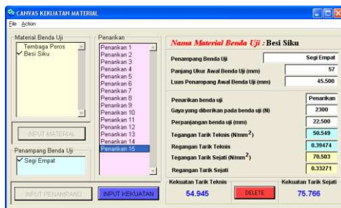
Gambar 4.4 Tampilan perangkat lunak pengujian tarik setelah pengisian data benda uji besi siku penampang segi empat
