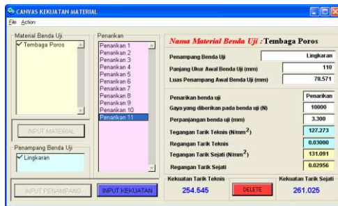
Gambar 4.3 Tampilan perangkat lunak pengujian tarik setelah pengisian data benda uji tembaga poros penampang lingkaran
