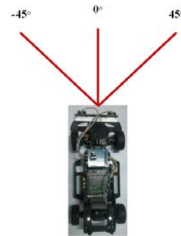
Gambar 4. Jangkauan Servo terhadap Mobil RC
