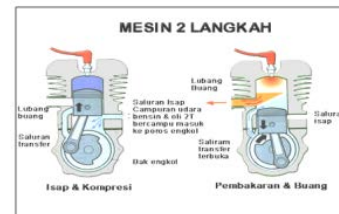
Gambar 3. Siklus Kerja ICE 2 Tak udara bergerak ke atas. Siklus kerja ICE dua tak dapat dilihat pada Gambar 3.
