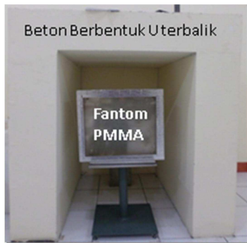
Gambar 2. Fasilitas beton berbentuk U terbalik
