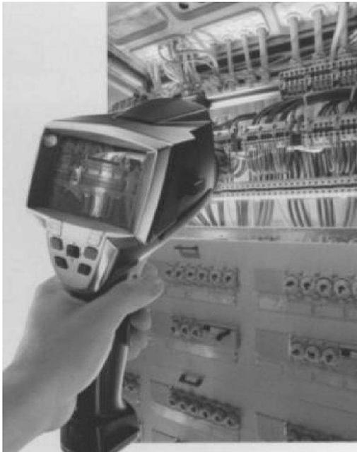
**Gambar 9.** Pengukuran dengan thermography.
