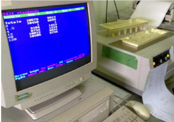
Gambar 7. Pengukuran dengan pencacah RIA
