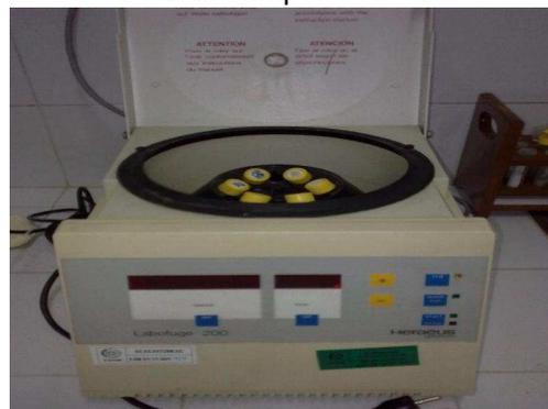
**Gambar 6.d.** Alat centrifuge
