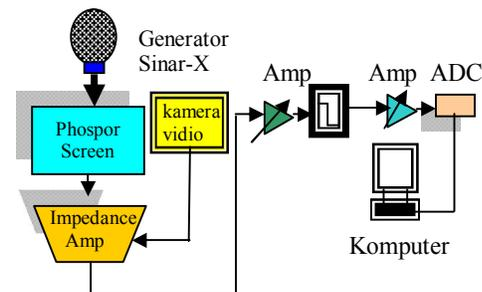
**Gambar 2.** Sistem Pesawat Sinar-X Fluoroscopy
