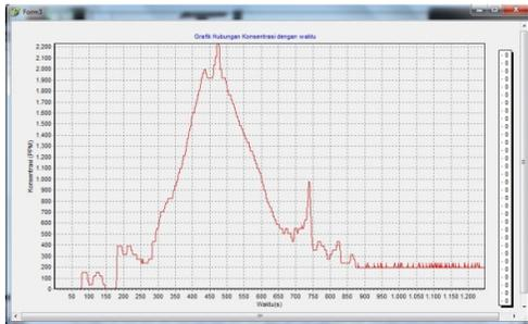
Gambar 11 Pengukuran Gas CO yang Ditampilkan pada Program *Display* PC.
